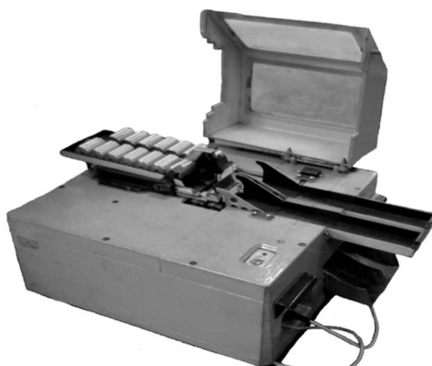
Рисунок В.7 — Электромеханический блок дефектоскопа ВД-13НФ
