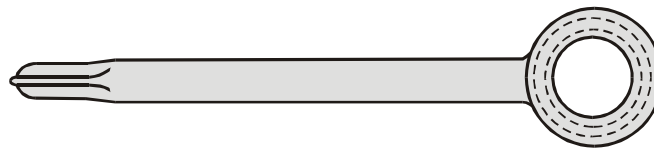
Рисунок 9.29 — Контроль поверхности вокруг отверстий подвески тормозного башмака
