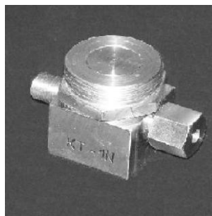
Рис. 4. Схема подключения течи «КТ-1» к магистрали с пробным газом, внешний вид течи «КТ-1»:
